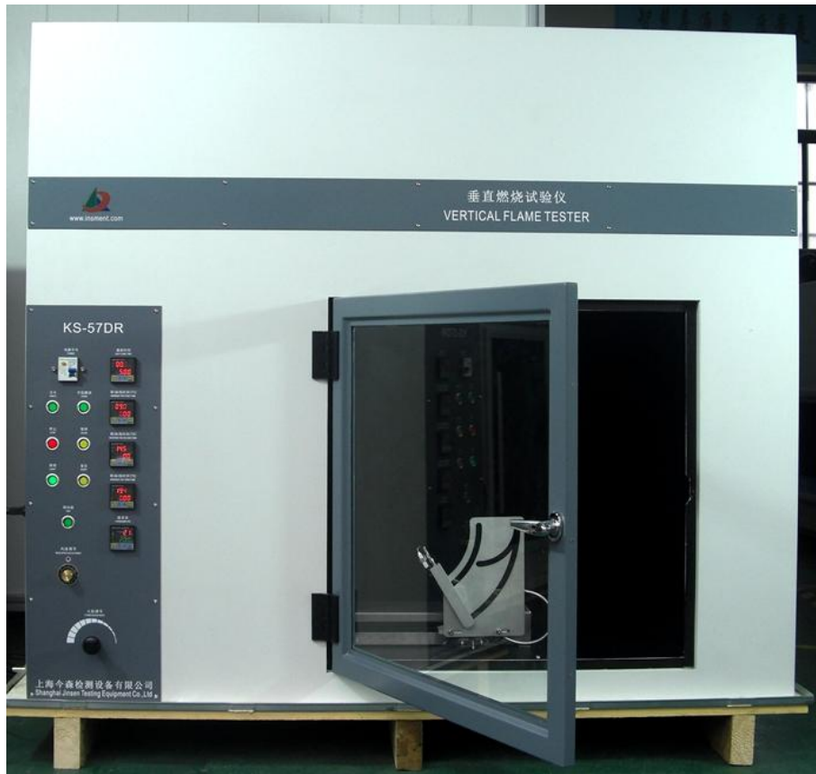
KS-57DR 汽车内饰材料垂直燃烧试验机
